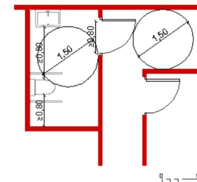
En este caso, basta con cambiar el sistema de apertura de la puerta de acceso para que no interfiera en los espacios de maniobra interior. Esta solución es posible siempre que el barrido de la nueva puerta con apertura hacia el exterior no interfiera en los espacios de circulación del pasillo y de maniobra de acceso al aseo.
