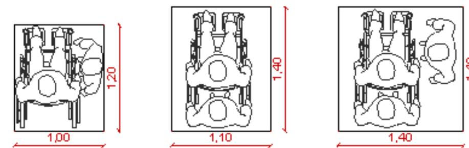
Un elemento importante es el espejo, da impresión de amplitud y luminosidad, reduce la sensación de claustrofobia y si en el interior no se puede realizar un giro completo de 150 cm, la persona usuaria de silla de ruedas ha de entrar o salir de espaldas y el espejo facilitará la orientación y la maniobra.
