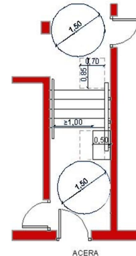
En el caso de que la anchura de escalera disponible no sea suficiente para que la instalación de una plataforma elevadora vertical deje espacio suficiente en la misma para la circulación de otros usuarios, una posible solución es instalar una plataforma inclinada en la escalera, que en posición de recogida, deje un ancho mínimo libre de escalera de 1 metro, permitiendo así la cómoda y segura circulación de otros usuarios.
