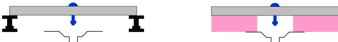
Fig. 3: Esquema de baldosas con un pasador incorporado para permitir su elevación, inspección y posterior mantenimiento (Dibujo izquierdo: para sistema sobre plots ; Dibujo derecho: sistema con aislante XPS integrado)
