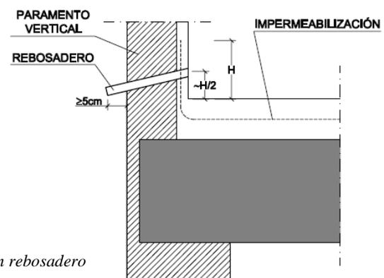
Fig. 3: Esquema de disposición de un rebosadero
