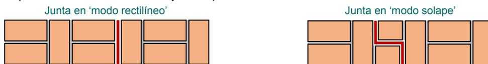
Fig. 8: Ejemplo de un aparejo gótico simple en una fábrica de 1 pie de ladrillo, en el encuentro con una junta de dilatación
