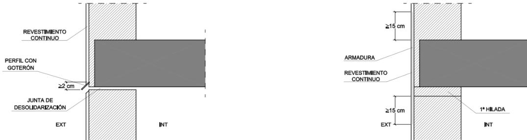
Fig. 4: Esquemas de los dos formatos posibles para la confluencia-uni3n entre las fachadas de f3brica y los forjados.
